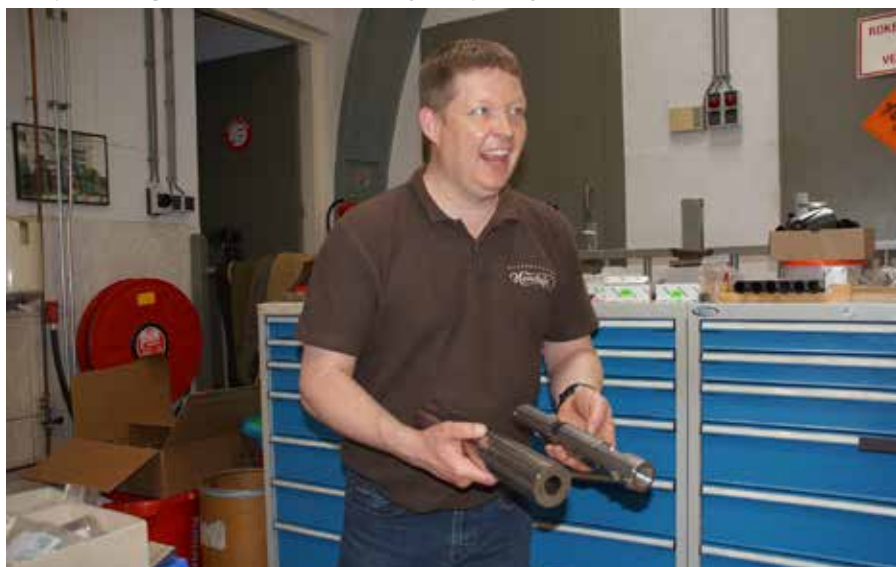
Links het blok waar vanuit het grendelhuis uit één stuk wordt gebouwd
