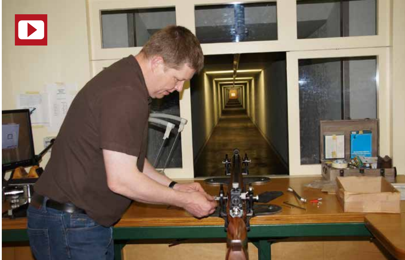
Op de speciaal voor de schutterijbuks ontworpen inschietbok test Michel Hendrix op zijn 100 meterbaan de zuiverheid van zijn 'bouwwerk'
