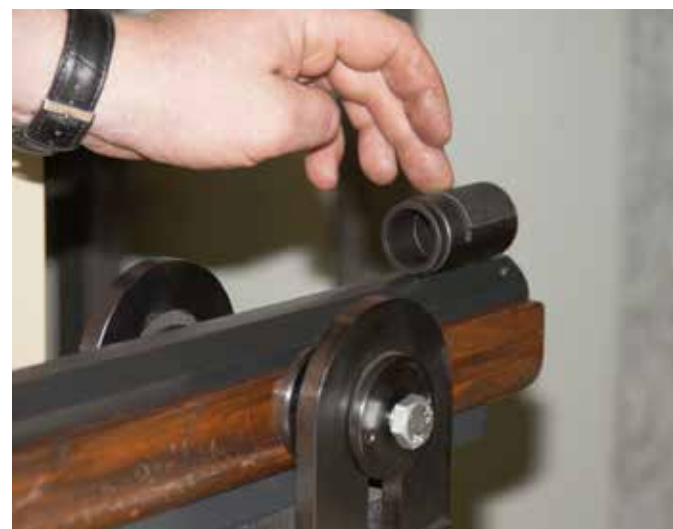
De nieuwste 32mm ringkorreltunnel is dankzij meer lichtinval een uitkomst voor de schutterijbuks bij wisselende weersomstandig- heden. De 32mm ringkorrel vervangt steeds vaker de 18 en 22mm korreltunnels
