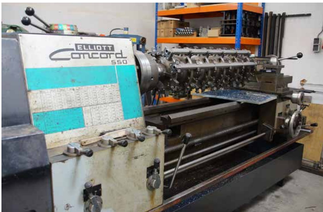
Het 'geheim' van de smidse van wapenmakerij Hendrix. Op deze machine worden loop en loopverlenger van acht kanten voorzien
